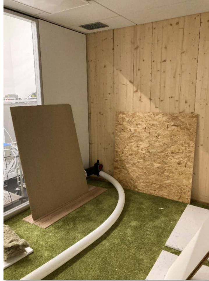
Beladung des Referenzraums mit verschiedenen Baumaterialien
