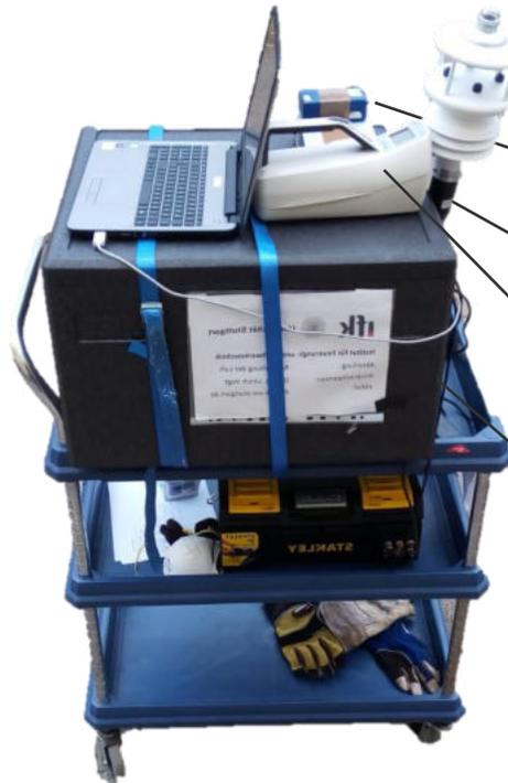
**Meteorologische Parameter:** Temperatur, Windrichtung, Windgeschwindigkeit, Solarstrahlung, Feuchtigkeit, Druck (Gill, Modell MaxiMet)
