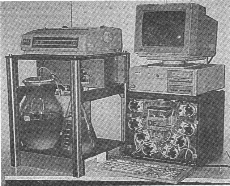
Abb. 6: Ansicht des DF- Algentests (rechts) mit Bioreaktor für die Algen (links).
