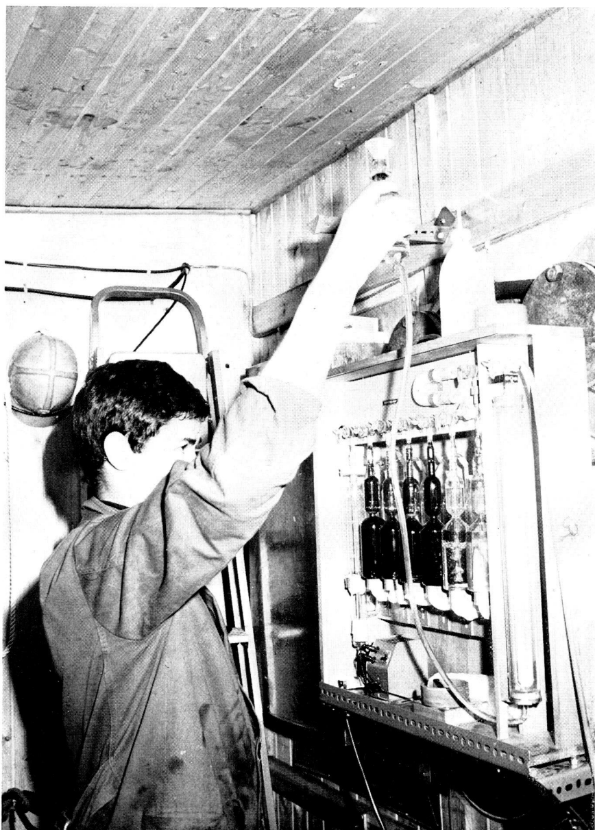
Abb. 10. Messung der Zusammensetzung des Rauchgases mit dem ORSAT-Apparat
