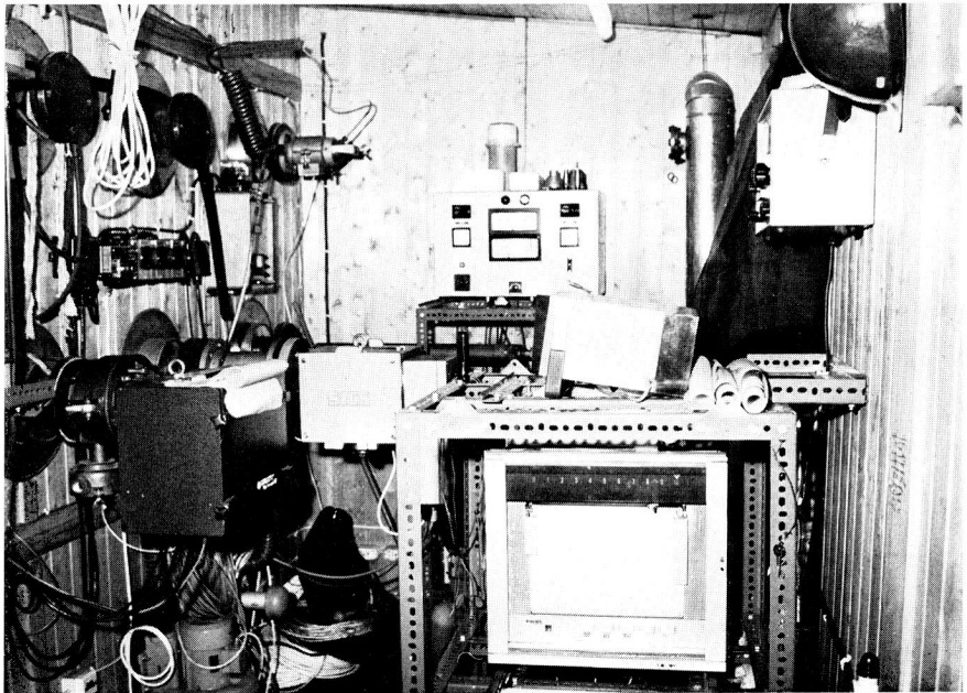
Abb. 5. Innenansicht des Meßraumes links vorn Durag-Gerät, links hinten Sick-Gerät, Mitte hinten Konitest, rechts vorn 24-Kanal-Punktdrucker
