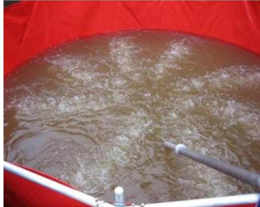
Faltbehälter mit Belüftungssystem (Pressluft)
