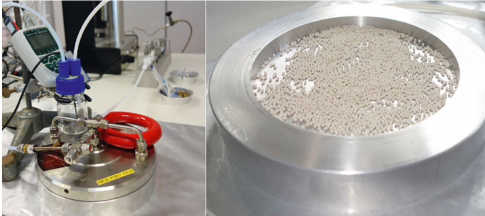
Abb. 2: Links: FLEC-Kammer und Luftfeuchtebestimmungsgesäß; rechts: 20 g Scavenger verteilt im zylindrischen Prüfraum (Höhe 13 mm)
