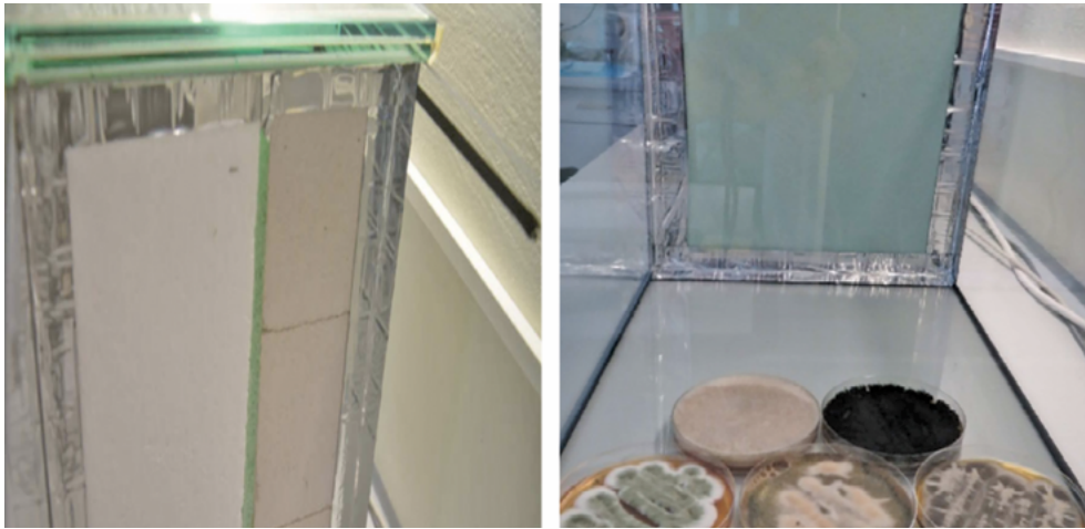
Abb. 6: Einbau eines Estrichrandstreifens bzw. eines Feuchtraumpaneels in die Simulationskammer (Quelle: AIBau, 2019, Abb. 62/63)
