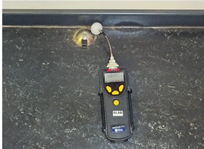
Abb. 2: PID-Messung zur Ermittlung des \text{TVOC}_{\text{PID}}
