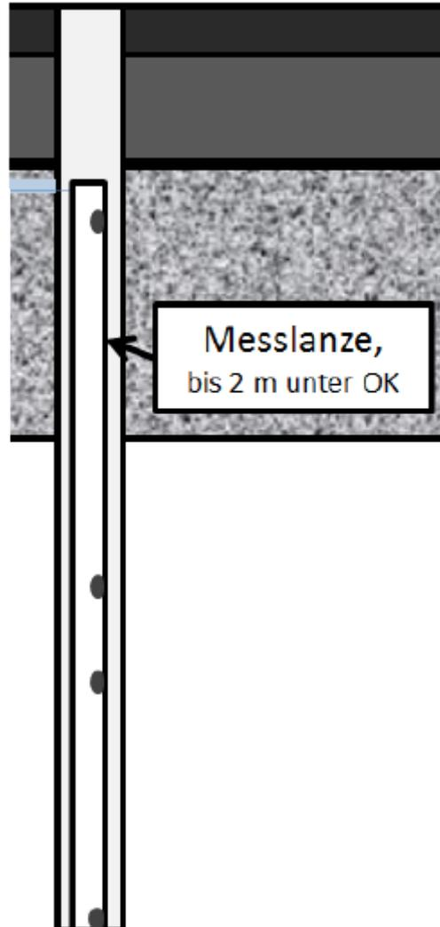
Die Temperaturlogger wurden in einem Rohr in verschiedenen Tiefen eingebaut.
