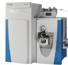
Identifizierung und Quantifizierung von Antihypertonika inkl. Transformationsprodukten mittels Flüssigchromatographie (UHPLC) mit Direktinjektion von 1 mL und hochauflösender Massenspektrometrie (HRMS) im Labor der Berliner Wasserbetriebe
