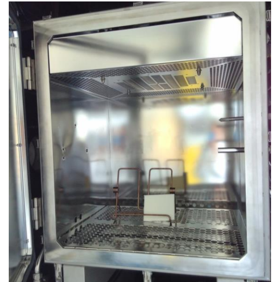
Standardplatte in der 203 L Kammer
