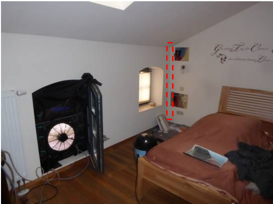
Foto 3: Mit Hilfe eines Blower-Door-Ventilators wird Unterdruck im Raum erzeugt
