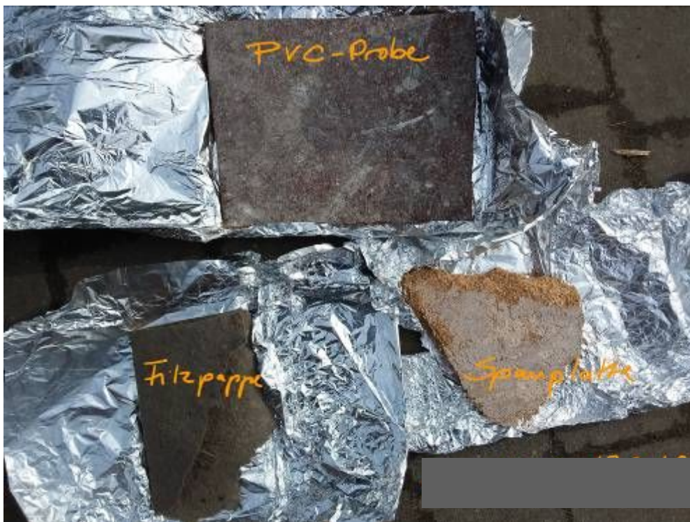
Foto 6: zugesendete Materialproben aus dem Fußboden
